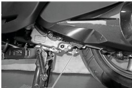
Vite di drenaggio (2)
