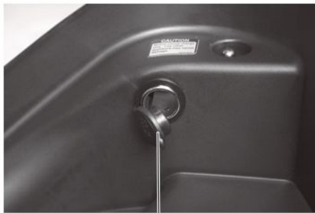
Preso 12 V nel vano sottosella
